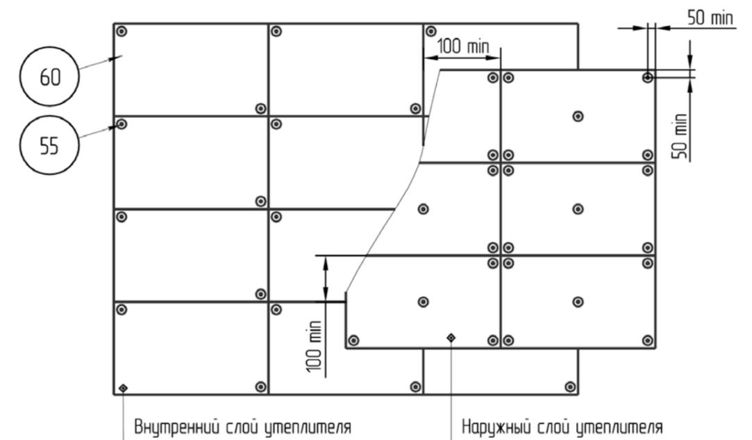
При применении нескольких слоев теплоизоляции плиты утеплителя наружного слоя монтируют с перекрытием швов внутреннего слоя. Плиты опорного (первого по высоте) ряда внутреннего слоя крепят тремя тарельчатыми дюбелями, а последующих – двумя дюбелями. Плиты наружного слоя и однослойного утеплителя крепят вместе с ветрогидрозащитной мембраной (если она необходима) пятью тарельчатыми дюбелями.
