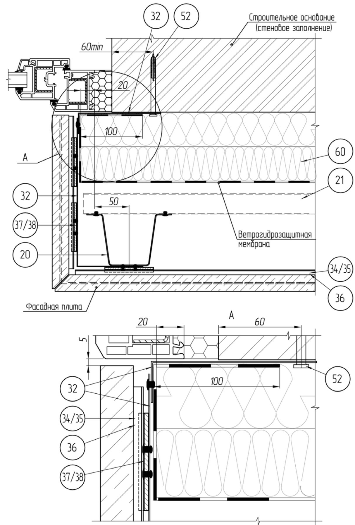
1. Пожарная отсечка (32) монтируется на всю высоту оконного откоса с шагом крепления к строительному основанию не более 600 мм и с шагом крепления к вертикальному профилю (20) не более 600мм.
