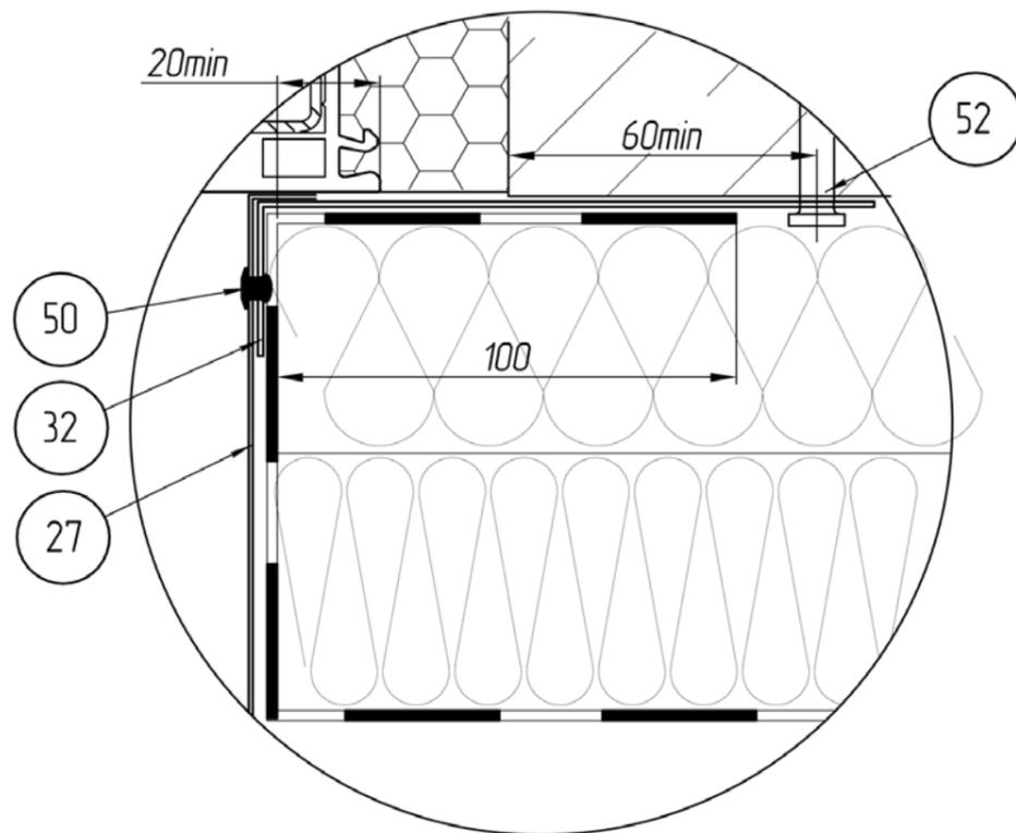
1. Пожарная отсечка (32) монтируется на всю высоту оконного откоса с шагом крепления к строительному основанию не более 600 мм.
