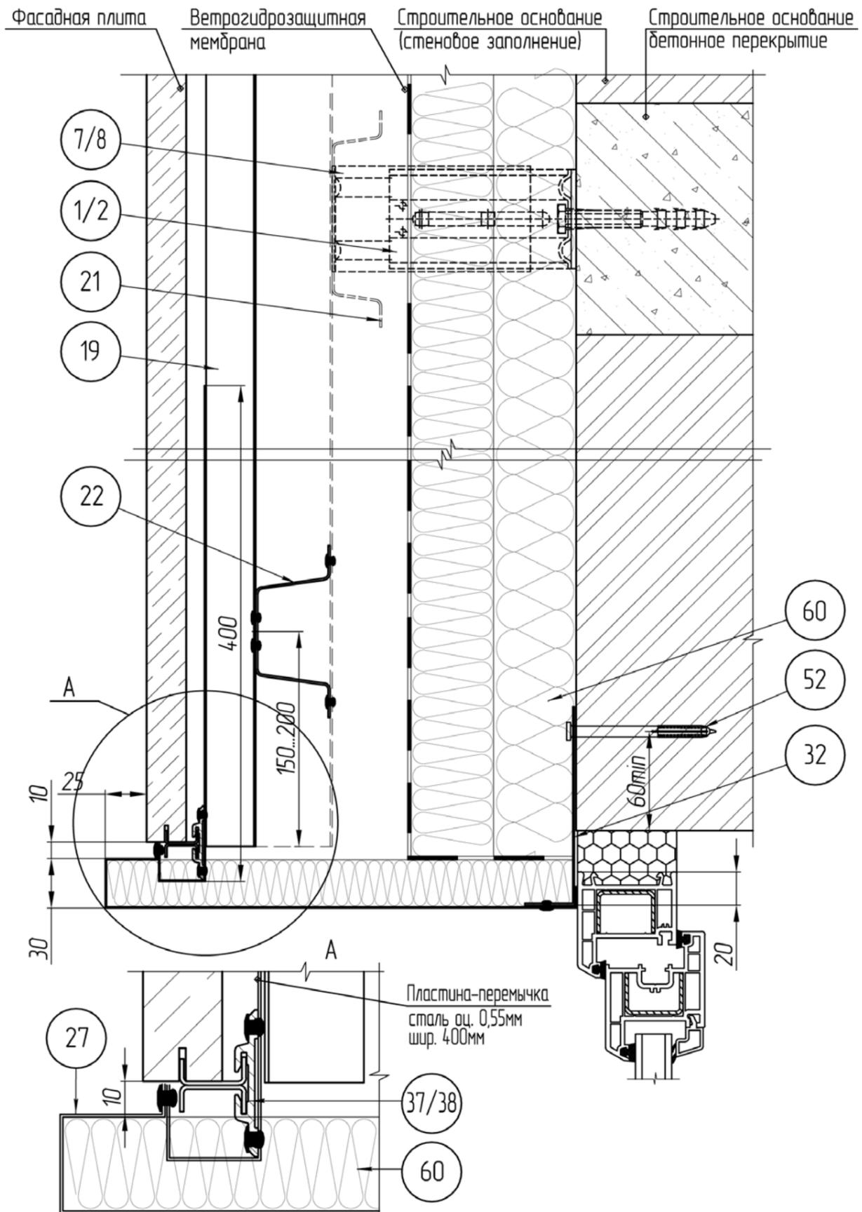
1. Пожарная отсечка (32) монтируется на всю ширину оконного откоса с шагом крепления к строительному основанию не более 400 мм.
