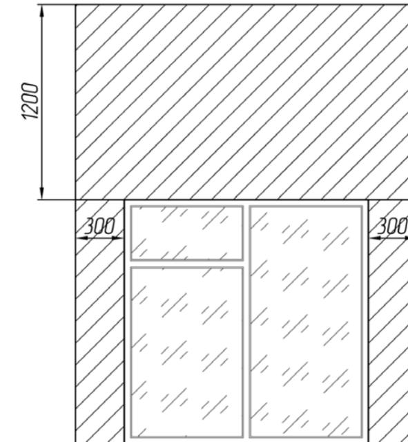
2. участок фасада с оконными проемами, принадлежащими одному помещению при расстоянии между ними 0,6м и менее
