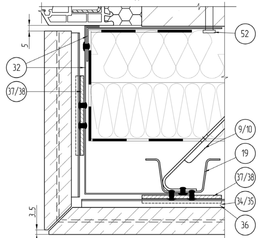
1. Пожарная отсечка (32) монтируется на всю высоту оконного откоса с шагом крепления к строительному основанию не более 600 мм и с шагом крепления к вертикальному профилю (19) не более 600мм.
