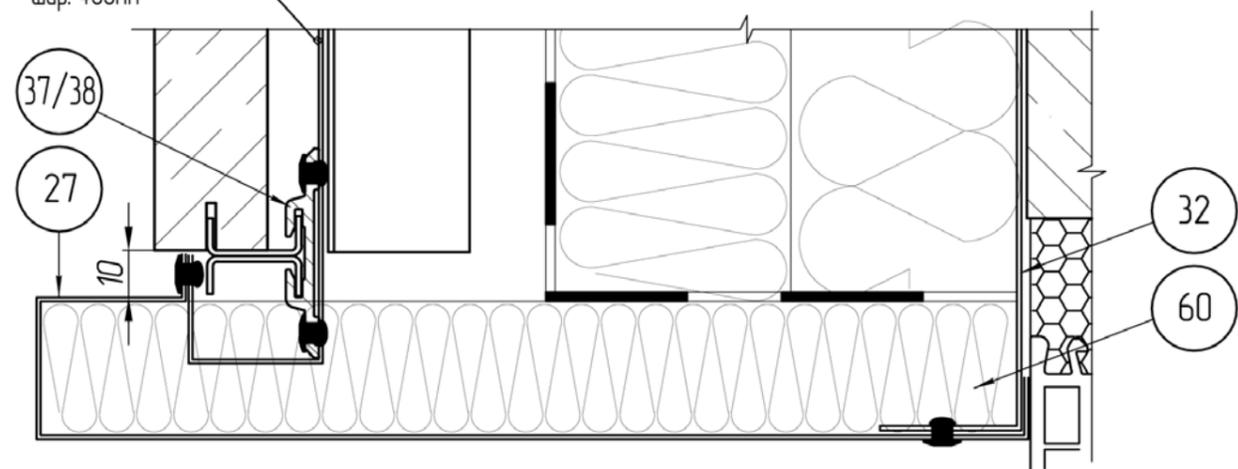
1. Пожарная отсечка (32) монтируется на всю ширину оконного откоса с шагом крепления к строительному основанию не более 400 мм.
