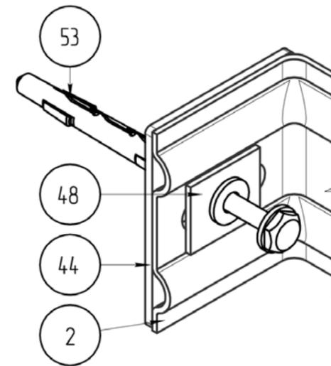
При креплении кронштейна к стене здания используется шайба специальная (48).
