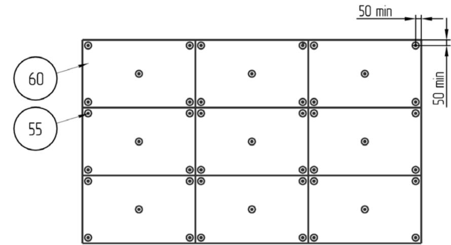
Схема крепления плит утеплителя в два слоя
