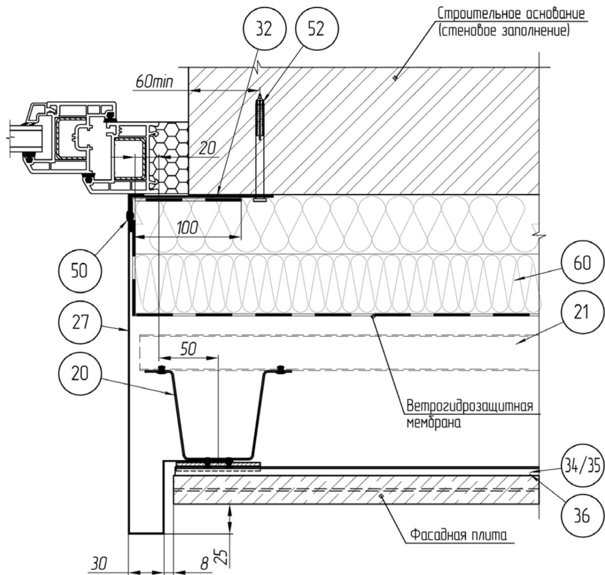
1. Пожарная отсечка (32) монтируется на всю высоту оконного откоса с шагом крепления к строительному основанию не более 600 мм.
